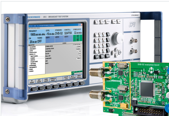
R&S®SFU mit DVB-S2 Evaluation-Board.
